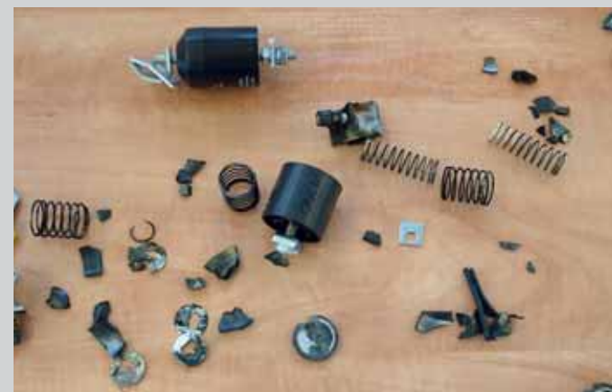
Rys. 11 Resztki ogranicznika przepięć.
