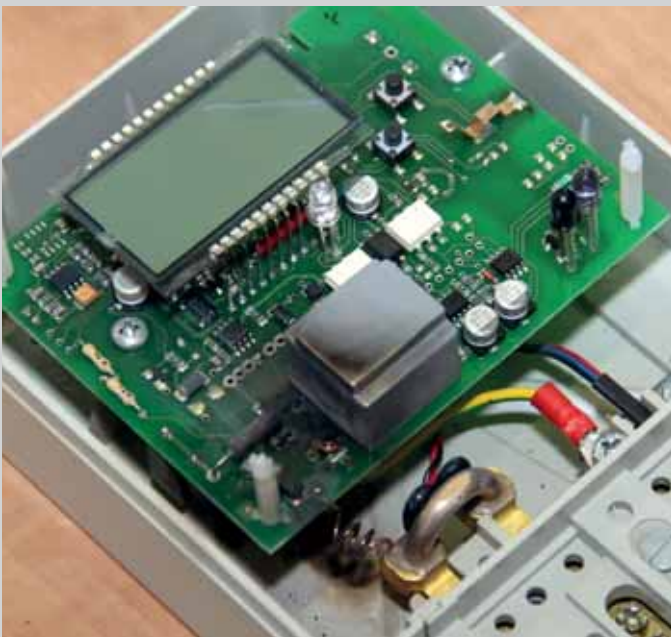
Rys. 7 Zdjęcia pokłatkowe licznika energii elektrycznej podczas badań
